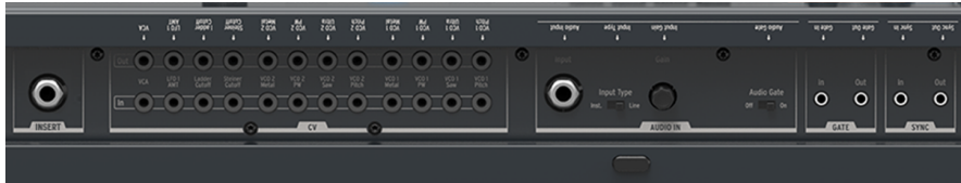
MatrixBrute Steuerspannungseingänge und -ausgänge
