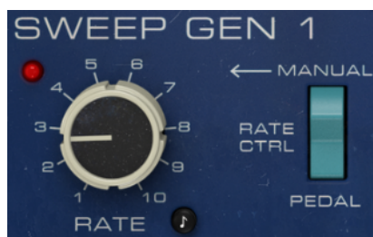
L'interrupteur qui active le contrôleur Pedal dans la section Sweep Gen 1
