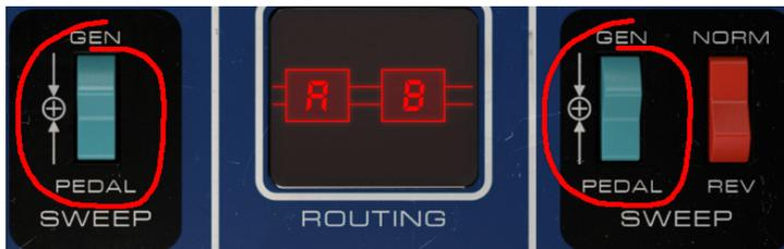
Los interruptores que activan el controlador de pedal en las dos secciones de fasor
