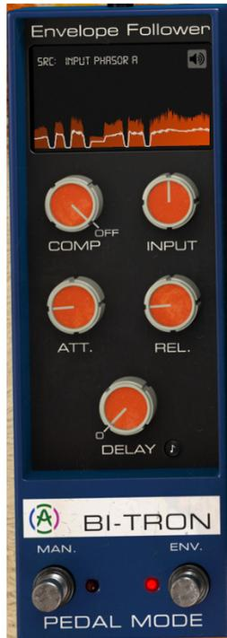
El "SRC" es donde seleccionamos la señal de control de la fuente de audio. Cuando se selecciona "Input Phasor A", la señal de entrada de Phasor A (mono) es la fuente para el seguidor de envolvente. Si la señal de entrada es estéreo, la fuente será el canal izquierdo.
