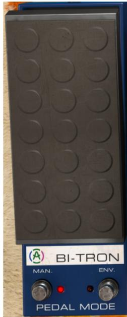
El pedal manual es un control muy simple (como el pedal real). Lo arrastramos hacia arriba para aumentar el valor de modulación, lo arrastramos hacia abajo para disminuir el valor de modulación, y eso es todo. También se puede automatizar.
