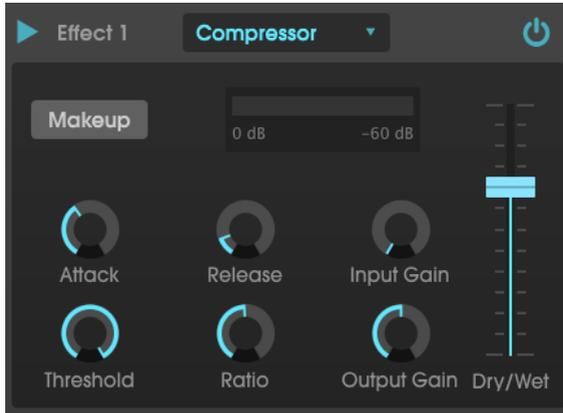
Wenn Sie zum Beispiel Effektketten verwenden, kann der Kompressor verhindern, dass die Attack-Transienten eines Sounds den Eingang des nächsten Effekts übersteuern. Er kann auch einen Klang pegelmässig unterstützen, der schnell abfällt. Schlagzeug wird oft komprimiert, um mehr "Punch" hinzuzufügen. Komprimierung wird auch bei Radio- und Fernseh-Audiosignalen hinzugefügt, um diese innerhalb eines bestimmten Lautstärkebereichs zu halten.
