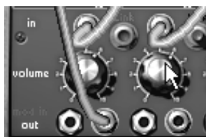
Réglage du volume des 2 VCA du mixeur
