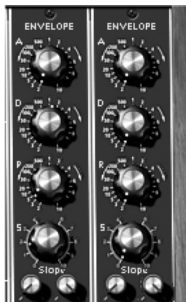
Le réglage des enveloppes des VCA
