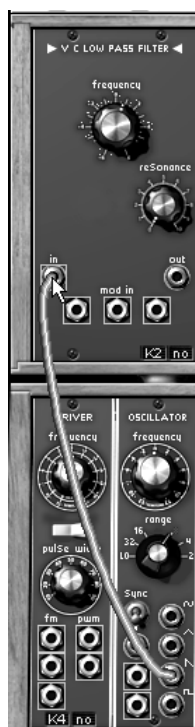
Connexion entre l'oscillateur 1 et le filtre1
