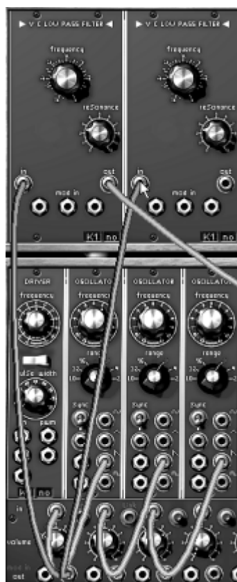
Câblage vers le second filtre
