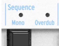
Para activar MONO presione Shift + Mono. Para restaurar la secuencia al modo poligonal, presione Shift + Mono nuevamente.
