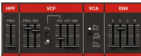
*Les filtres du Jun-6 V (le filtre passe haut -HPF- et le filtre passe bas contrôlé en tension -VCF-) et le générateur d'enveloppe*
