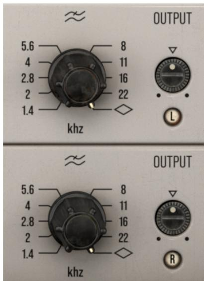
ステレオモード時のハイカットフィルターと OUTPUTノブ。OUTPUTノブの下の表示がLとRですので、M/Sモードではなくステレオモードになっています。
