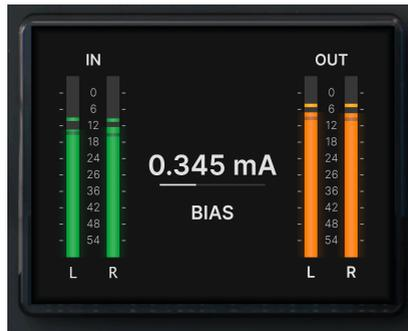
Diese Meter-Ansicht zeigt präzise Stereo-Balkendiagramme der Ein- und Ausgangssignale. Der mittlere horizontale Balken stellt den [Bias \[p.26\]](#) in Milliampere dar, also die gleichen Informationen wie beim analogen [Ampere-Meter \[p.29\]](#) in der Basisansicht.
