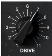
Der **Drive**-Regler legt fest ein, wie laut die virtuelle Eingangsröhrenschtaltung (Valve) angesteuert wird, analog zum „Pre Gain“ bei einem Gitarrenverstärker oder Mikrofonvorverstärker. Obwohl alle Regler in diesem Bereich miteinander interagieren, erzeugen höhere Einstellungen im Allgemeinen auch mehr Overdrive oder Verzerrung.
