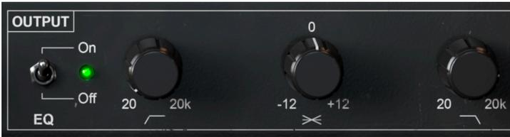
Das Ausgangsmodul im erweiterten Beidenbereich von Dist TUBE-CULTURE verfügt ebenfalls über 24dB-pro-Oktave-Hochpass- und Tiefpassfilter für das Post-Processing-Signal.
