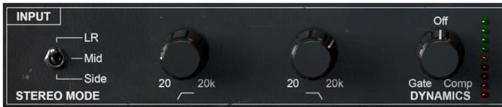
Der Eingangsbereich im erweiterten Bedienfeld kann ein Hochpass- und Tiefpassfilter auf das eingehende Signal anwenden, so dass nur die durchgelassenen Frequenzen vom Dist TUBE-CULTURE bearbeitet werden. Sie haben zusätzlich eine gewisse Kontrolle darüber, welche Aspekte des Stereo-Klangfelds durch das Plug-In beeinflusst werden.
