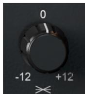
Der mittlere Regler im Ausgangsmodul „kippt“ den Ausgangs-EQ in die eine oder andere Richtung. Das heißt, er erzeugt eine Aufwärts- oder Abwärtsneigung im Spektrum. Diese sogenannte Slope dreht bei 630 Hz, hat einen Regelbereich von -12 bis +12 dB und wird im [Advanced-Meter \[p.35\]](#) angezeigt, das nachfolgend beschrieben wird.
