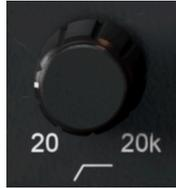
Der erste Regler ganz links im Eingangsbereich steuert die Cutoff-Frequenz des Hochpassfilters mit 24 dB pro Oktave. Das ist nützlich, um niedrige Frequenzen des Eingangssignals abzusenken und nur Signalinhalte oberhalb der Grenzfrequenz zu beeinflussen.
