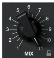
Ein unkomplizierter Dry/Wet-Mix-Regler, der das bearbeitete Signal im Verhältnis zum unbeeinflussten Signal einstellt.
