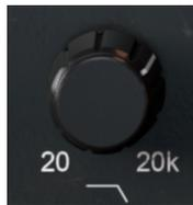
Der nächste Regler in der Reihe steuert die Cutoff-Frequenz des Tiefpassfilters mit 24 dB pro Oktave, der Signalinhalte oberhalb der Cutoff-Frequenz entfernt. Sie können das nutzen, wenn Sie das "Low-End" eines Klangs „fetter“ machen möchten, während der Signalanteil der Mitten und/oder Höhen unbearbeitet bleiben soll.
