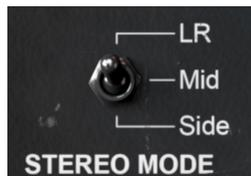
Inspiziert von der Mitten-Seiten-Stereo-Aufnahmetechnik können Sie mit diesem Kippschalter bestimmen, welcher Teil des Stereosignals vom Plug-In beeinflusst wird.
