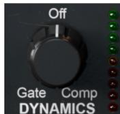
Der Eingangsbereich des Dist TUBE-CULTURE bietet eine One-Knob-Dynamikanpassung. Von der 12 Uhr-Position im Uhrzeigersinn gedreht fungiert dieser als Aufwärtskompressor. Gegen den Uhrzeigersinn gedreht, agiert dieser als gradueller Expander/Gate.
