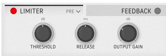
Un limiteur est un compresseur en plus simple : il définit un « mur » de volume absolu au-delà duquel aucun signal n'est autorisé. Les temps de release courts entraîneront un son plus agressif, fort et compressé ainsi qu'une plus grande distorsion. Avec des temps de release plus longs, le son sera nettement moins déformé au prix d'un volume sonore moindre et d'un pompage plus important.
