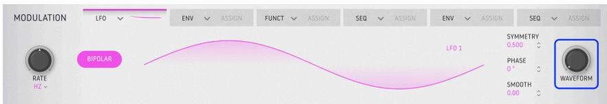
Le LFO est capable de morpher en continu via son bouton **Waveform** d'une onde sinusoïdale, à une triangulaire, à une dent de scie, à une carrée. Quand le bouton est à 100 % (dans le sens des aiguilles d'une montre), il se transforme en LFO sample & hold.
