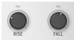
**Rise** correspond au bouton Attack d'un compresseur : il définit le temps qu'il faut au Follower pour « s'accrocher » à l'audio entrant et pour le traduire en résultats. Sur un compresseur, ces résultats sont de la réduction de gain qui suit le volume global. (Eh oui, un compresseur est aussi un suiveur d'enveloppe par définition).
