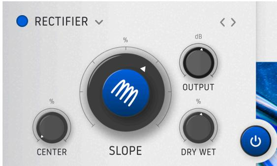
Dans le monde de l'amplificateur à tube, un Rectifier (redresseur) est un type de tube à vide (lampe) qui convertit le courant alternatif en courant continu. En tant qu'effet sonore, il modifie la partie négative de la forme d'onde, ce qui produit un type de distorsion et de waveshaping unique.
