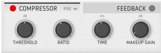
Ce compresseur punchy tient aussi son caractère de notre plugin Bus FORCE. Les compresseurs font office de main supplémentaire sur un contrôle de volume ou sur un fader, réagissant en temps réel au niveau du signal et en réduisant le gain.
