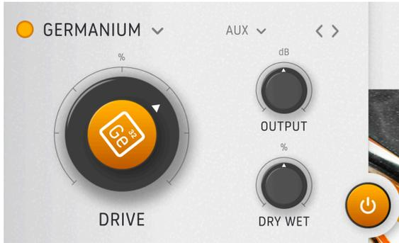
L'option Germanium modélise l'étage de préampli d'une réverb à ressort vintage, comme émulée dans notre plugin Rev SPRING-636. Le germanium était un matériau utilisé sur les transistors, les amplis et les préamplis. Ceux qui en contenaient avaient un son flou et saturé typique. Cette option modélise uniquement l'étage d'entrée, pas la réverb en elle-même. Les contrôles sont :
