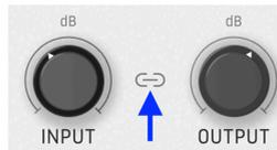
Si le bouton **Link** entrée-sortie est activé, augmenter le niveau d'entrée diminuera le niveau de sortie. Cette fonction est pratique pour éviter l'écrêtage.
