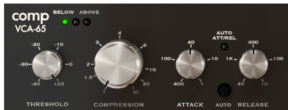
Controles principales del compresor
