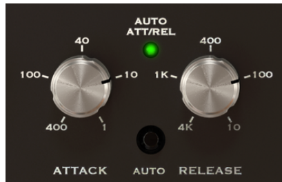
Perillas de control de Ataque y Liberación. En medio, podemos ver el botón Auto activado
