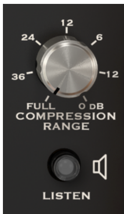
Control de rango de compresión completo y controles de escucha del Comp VCA-65
