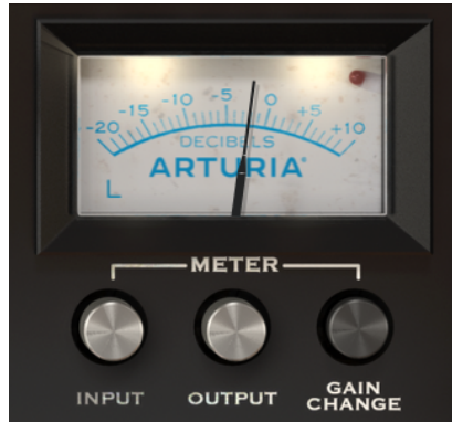
Medidor del VCA-65 Comp, mostrando la reducción de ganancia
