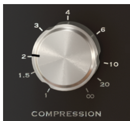
El Comp VCA-65 con el control de compresión ajustado a una relación de 2: 1
