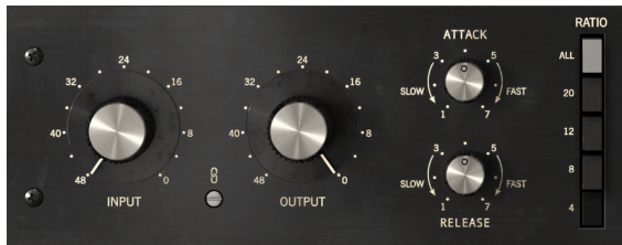
FET-76のメインのコントロール部
