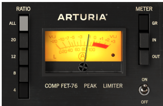
ゲインリダクション表示モードのVUメーター。メーター左下隅にLの文字が、右下隅にクリップインジケータLEDがあります
