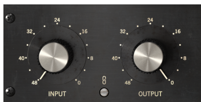
デフォルト設定時のInputとOutputノブ。両者の間にLinkスイッチが見えます。
