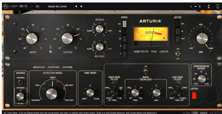
FET-76 configurado para actuar como limitador
