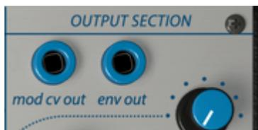
Der "env out" ist nicht, wie vielleicht anzunehmen, ein zusätzlicher Steuerspannungsausgang des Hüllkurvengenerators, sondern der Envelope Follower, der ein Bestandteil des Pre-Amps ist. Eine ausführliche Beschreibung finden Sie im Abschnitt zum [Pre-Amp \[p.77\]](#).
