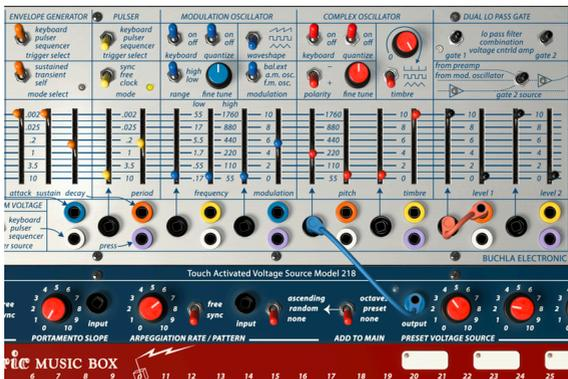
Der Ausgang der Preset Voltage Source steuert den Complex Oscillator
