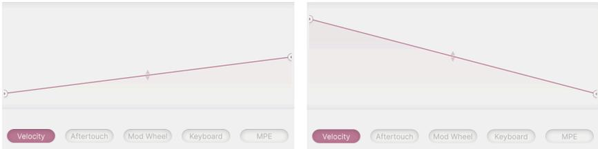
*izquierda: una respuesta lineal a escala reducida. Derecha: una respuesta invertida.*
