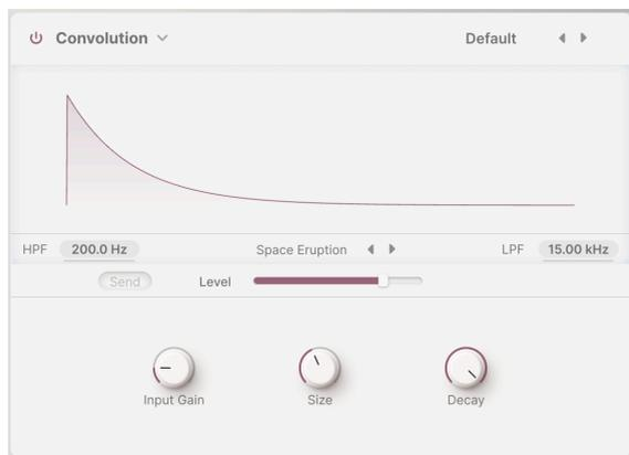
La reverb de convolución de Main FX es otro animal completamente distinto. La idea de la *convolución* es extraordinariamente sencilla: creas un sonido bien entendido (como el disparo de una pistola detonadora, una ráfaga de ruido blanco o una onda sinusoidal que barre hacia arriba en frecuencia) en un espacio acústico, lo grabas y luego eliminas matemáticamente el sonido original.
