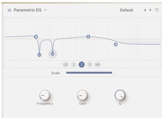
Un **Ecuador paramétrico** te permite esculpir tu sonido con mucha precisión, a diferencia de los trazos tonales muy amplios que se obtienen con un ecualizador gráfico o los controles de tono de una guitarra o un amplificador. Se puede utilizar para realzar o cortar suave o quirúrgicamente determinadas frecuencias para alterar el sonido general de una pista o eliminar frecuencias problemáticas.
