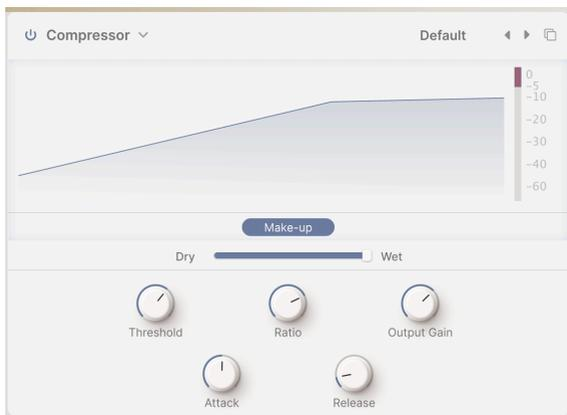
El **Compresor** se utiliza para controlar el rango dinámico de un sonido: reduce la diferencia entre los niveles más suave y más fuerte que puede tener un sonido.
