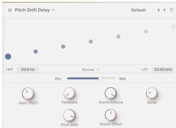
**Pitch Shift Delay** es un efecto clásico que se remonta a los primeros años del procesamiento digital de audio, popularizado por el Eventide Harmonizer. Funciona como un delay convencional, pero además de retroalimentarse para crear ecos, las señales de audio con delay se someten a un desplazamiento de tono, hacia arriba o hacia abajo.
